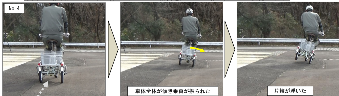
写真10. 傾斜面に進入する様子（スイング機構を固定した場合、進入速度約6km/h）
